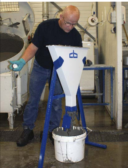
• Bepalen van de viscositeit van ZVB door middel van de trechtertijd.
