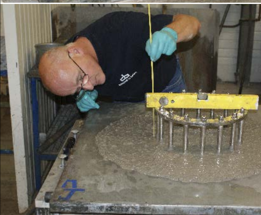
• Met de J-ringtest wordt vastgesteld dat de betonsamenstelling voldoende om de wapeningsstaven vloeit.
