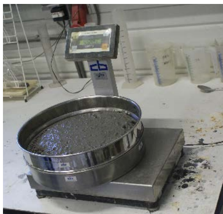
• Voor het bepalen van de stabiliteit van de ZVB samenstelling wordt de hoeveelheid uitvloeiing, ofwel segregatie, op een vastgestelde zeefmaat gemeten.
