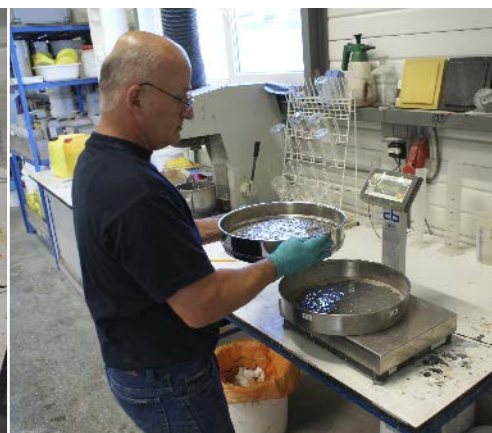
• Voor het bepalen van de stabiliteit van de ZVB samenstelling wordt de hoeveelheid uitvloeiing, ofwel segregatie, op een vastgestelde zeefmaat gemeten.
